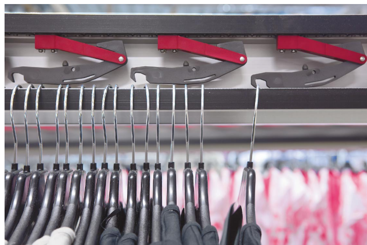
TX 200 ist ein "Power and Free"-Förderer, der große Mengen an Einzelteilen über lange Strecken aufstauen und dann Teil für Teil wieder freigeben kann.
