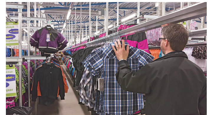
Durch den Kunststoffbelag der Schiebestrecke ist es einfach, auch viele Teile gleichzeitig zu schieben.
