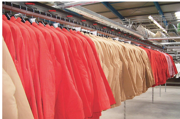
Die TX 200 "Power and Free"-Förderer wurden entwickelt, um große Mengen an Kleidungsstücken ohne Staudruck zu speichern.
