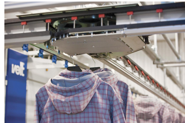
Die patentierten automatischen Weichen ohne Höhendifferenz.
