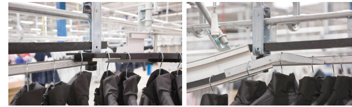
Trolleybe- und entladung. Die Verbindung zwischen dem Rutschstangensystem und der Trolleybahn ist die kostengünstigste Lösung, um die langen Wege zum statischen Lager zu überbrücken.
