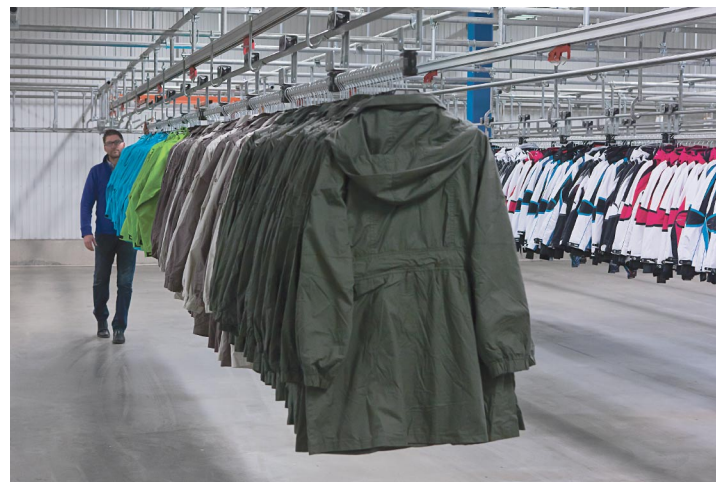
Von der Laufschiene kann ein gesamter Trolleyzug in den Förderer eingeschoben werden.
