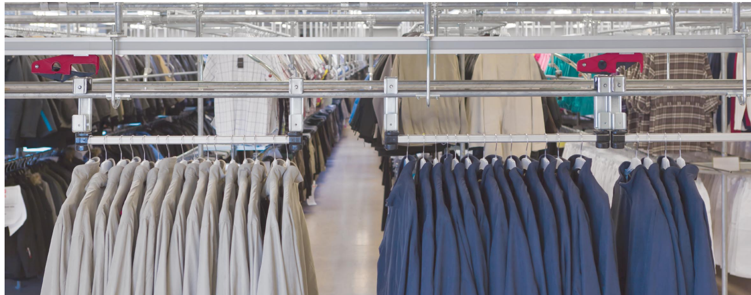
Die Mitnehmerklinke nimmt automatisch nur einen Trolley Ihres Trolleyzuges mit und kann gleichzeitig Trolleys in einer Reihe aufstauen.
